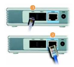
Paso 3: Conecta el otro extremo del cable de red a una boca libre de su router, swicht o hub, ADSL (puerto Ethernet)
